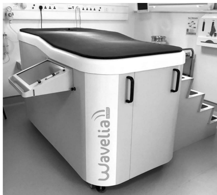
Рис. 8. СВЧ-маммограф фирмы Wavelia.
